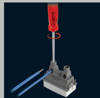
Doble embornamiento. Los mecanismos permiten la conexión en cada borne de dos conductores de calibre 12AWG (3.3 mm de sección)
